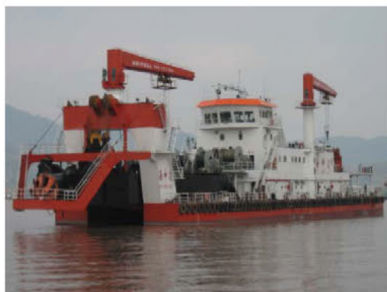
3800m³/h绞吸挖泥船 3800m³/h Cutter Suction Dredger
