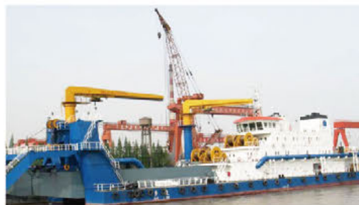
南京航道工程局3000m 3 /h绞吸挖泥船 Changjiang Nanjing Waterway Bureau 3000m 3 /h Cutter Suction Dredger
