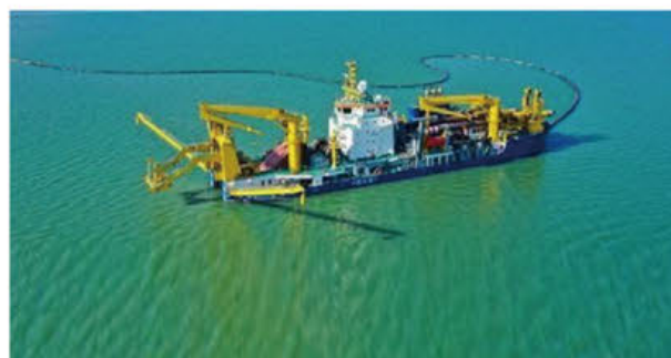
亚洲最大重型自航绞吸船“天鲲号” “Tiankun”, El buque de succión de corte autopropulsado pesado más grande de Asia.
