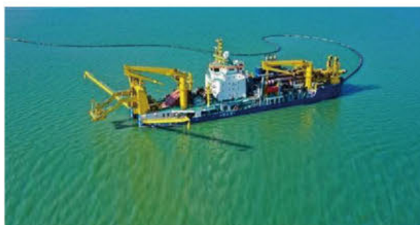
Крупнейший в Азии тяжелый самоходный землесос “Тянькунь” 亚洲最大重型自航绞吸船 “天鲲号”
